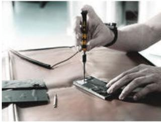
Bei der Verschraubung von Elektronikkomponenten (wie z. B. in Smartphones und Tablet-PCs) dürfen keine elektrostatischen Entladungen auftreten, da diese Fehlfunktionen bis hin zu einem Totalausfall verursachen können. Daher sind elektrostatisch abgesicherte Schraubwerkzeuge unabdingbar.
