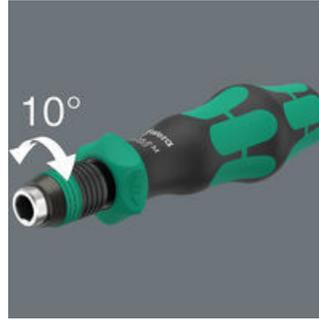
Die integrierte Ratsche mit Feinverzahnung (36 Zähne) und einem Rückholwinkel von 10° vereinfacht und beschleunigt das Schrauben ohne mühsames Neuansetzen. Mit ergonomischem Kraffform Griff und Schnellwechselfutter Rapidaptor.
