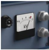
Die Stückprüfung der Werkzeuge bei 10.000 Volt gemäß IEC 60900 garantiert sicheres Arbeiten unter Spannung bis 1.000 Volt.
