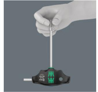
Die Klemmung der Innensechskant-Schraube auf der Werkzeugschale wird durch eine federnde Kugel gewährleistet. Besonders hilfreich in schwer zugänglichen Arbeitsbereichen, wo man die zweite Hand nicht zum Festhalten der Schraube nutzen kann.
