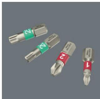
BiTorsion Bits sind absolute Premium-Bits. Mit weicherer BiTorsion-Zone, wodurch die Härte des Schaftes um ca. 20 % gegenüber der Abtriebsspitze reduziert wird. Dadurch wird das Verwinden der Bitspitze bei auftretenden Belastungsspitzen größtenteils vermieden, was die Lebensdauer des Bits noch weiter erhöht.
