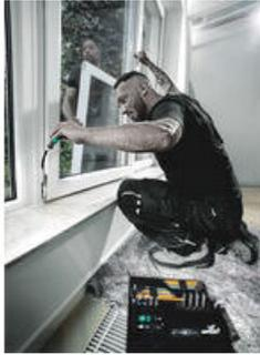
Mit dem Schraubendreher 393 S kann auch um die Ecke geschraubt werden. Durch den flexiblen Schaft können ungünstig positionierte Befestigungsschrauben erreicht werden. Das ideale Werkzeug für schwer erreichbare Verschraubungssituationen.
