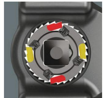
Gibt den robusten 30 Sägezähnen den feinmechanischen Effekt einer 60er Feinverzahnung mit 6° Rückholwinkel.
