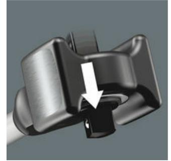
Der Richtungswechsel mittels Durchsteckvierkant garantiert eine sehr hohe Belastbarkeit, da eine durch Hammerschläge zerstörungsanfällige Schaltmechanik entfällt.
