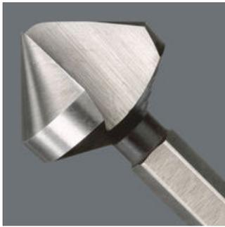
1-nutiger Kegelsenker-Bit, 90°-Einsatz: Entgraten und Senken</li><li>1/4"-Antrieb passend für Halter nach DIN 3126-D 6,3 (ISO 1173)</li><li>Sehr gute Kraftübertragung durch Sechskantschaft</li><li>1 Schneide</li><li>Garantiert ratterfreies und riefenfreies Arbeiten</li><li>Beste Oberflächengüte der Senkung</li><li>Hohe Standzeit</li><li>Einwandfreie Spanabfuhr</li><li>Hoher Korrosionsschutz</li></ul>
