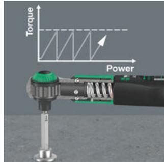
Der Drehmomentschlüssel Safe-Torque A 2 ist mit einer Überschnellmechanik ausgestattet. Nach Erreichen des eingestellten Drehmomentwertes kann das Werkzeug nicht überzogen werden, so dass das Aufbringen eines zu hohen Drehmomentes ausgeschlossen ist.
