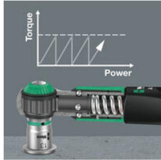
Der Drehmomentschlüssel Safe-Torque A 1 ist mit einer Überrutschmechanik ausgestattet. Nach Erreichen des eingestellten Drehmomentwertes kann das Werkzeug nicht überzogen werden, so dass das Aufbringen eines zu hohen Drehmomentes ausgeschlossen ist.
