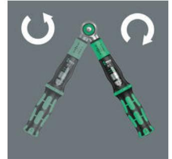
Der Drehmomentschlüssel Safe-Torque ist für Rechts- und Linksanzug mit eingestelltem Drehmoment geeignet. Bei ausgeschalteter Torque Lock Funktion erfolgt das Anziehen und Lösen ohne Drehmoment.
