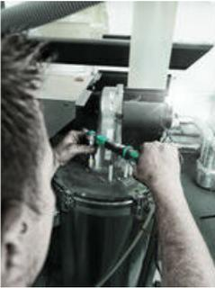
Der Safe-Torque Drehmomentschlüssel A 1 hat eine 1/4" Vierkantaufnahme und ist für 1/4" Steckschlüsseleinsätze geeignet.
