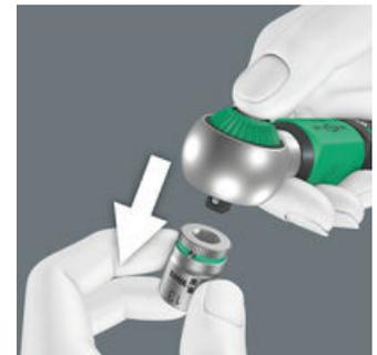
Die Kugelarretierung sorgt für sicheren Sitz der Nüsse und des Zubehörs und damit auch für verlässliche Sicherheit während des Verschraubens. Ein kurzer Druck auf den Auslöseknopf auf dem Kopf der Knarre und die Kugelarretierung wird gelöst.
