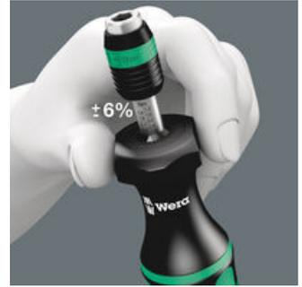
Messgenauigkeit  $\pm 6\%$  (Artikel 1430:  $\pm 10\%$ ) nach Norm DIN EN ISO 6789. Deutlich hör- und spürbares Übertasten beim Erreichen des eingestellten Drehmoments.
