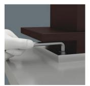
Anwender Jeder kennt seine Winkelschlüssel mit selbst abgesägten bzw. abgeschliffenen kurzen Schenkeln für besonders beengte Verschraubungsfälle. Diese haben den Nachteil, dass sie zum einen keinen Korrosionsschutz mehr an der Trennstelle aufweisen und zum anderen ggf. durch zu hohe Temperaturen beim Trennen "weich" und unbrauchbar geworden sind.
