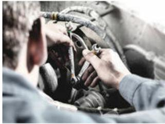
In nahezu jeder denkbaren Situation löst der Joker Schraubaufgaben in hoher Geschwindigkeit und mit hoher Präzision. Seine Ratschenmechanik auf der Ringseite weist eine außergewöhnlich hohe Feinverzahnung mit 80 Zähnen auf und sorgt für Flexibilität auch in engen Bauräumen.
