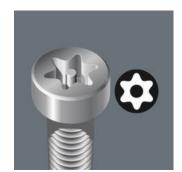
Konstruiert, um unerlaubtes Lösen von sogenannten Sicherheitsverschraubungen zu verhindern. Um eine Verwendung "normaler" TORX® Werkzeuge nicht zuzulassen, besitzen die Schrauben in ihrem Antriebsprofil einen vorstehenden Zapfen. Dieser wird in der Bohrung der TORX® BO Werkzeuge aufgenommen und die Sicherheitsverschraubung kann gelöst werden.
