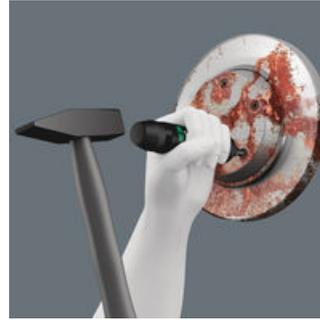
Festsitzende Schrauben ohne Maschineneinsatz lösen und anziehen.
