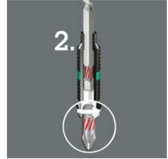
Größere Belastungsspitzen werden durch die Torsionswirkung des Bit-Schaftes minimiert (Phase 2).
