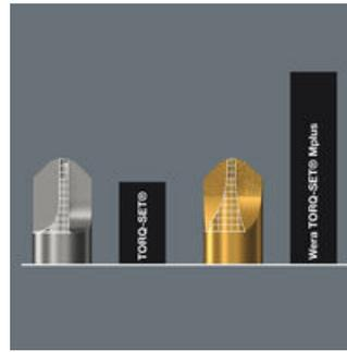
Das von Wera entwickelte Mplus Profil weist gegenüber Werkzeugen mit dem konventionellen TORQ-SET® Profil stärkere Flanken auf. Dadurch ergibt sich ein wesentlich höheres Bruchdrehmoment und eine vielfach längere Lebensdauer des Werkzeugs.
