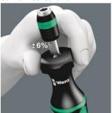
Von Hand verstellbar auf entsprechende Skalenwerte. Einfache Einstellung des benötigten Drehmomentwerts von Hand. Messgenauigkeit ± 6 % nach Norm DIN EN ISO 6789. Deutlich hör- und spürbares Überrasten beim Erreichen des eingestellten Drehmoments.
