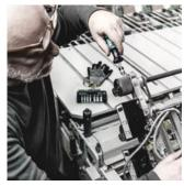
Viele Schraubverbindungen bei Montage - und Servicearbeiten müssen drehmomentkontrolliert angezogen werden, um die Sicherheit der Schraubverbindung zu gewährleisten und/oder Schäden an Schraube oder Werkstück zu vermeiden. Die einstellbaren
