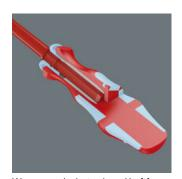
Wera produziert den Kraftform-Griff aus mehreren Materialien mit unterschiedlichen Eigenschaften. Für den Kern wird widerstandsfähiger Kunststoff eingesetzt, der die Klinge auch bei hohen Belastungen sicher hält. Für die farbigen Kontaktzonen wird ein weicheres Material verwendet. Das Material hat Reibungswiderstand und erlaubt die Übertragung größerer Kräfte. Die roten Bereiche mit ihrer härteren Oberfläche verhindern das "Festkleben" der Hand am Griff. Schnelles Umgreifen ist möglich.
