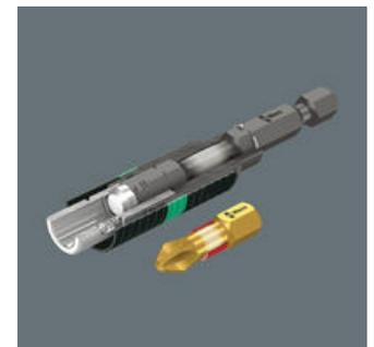
Die optimal abgestimmten Kennlinien der Torsionszonen von Bit und Halter ermöglichen ein abgestuftes Nachgeben bei Belastung. Das zweistufige System verhindert frühzeitigen Verschleiß. Darüber hinaus ist ein langes Werkzeugleben auch durch die jeweilige Anwendung ausgelegte Härte der Bits garantiert.
