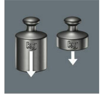
Diamantpartikel reduzieren die bei maschineller Verschraubung besonders hohen Cam-Out Kräfte, die zum Herausrutschen aus der Schraube führen können. Die Diamant-Partikel beißen sich in der Schraube fest. Dadurch ist weniger Anpressdruck notwendig, was die Ermüdung beim maschinellen Verschrauben deutlich verzögert.
