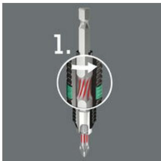
Die im BiTorsion-Halter integrierte Torsionsfeder sorgt für das Abfedern kleinerer Belastungsspitzen (Phase 1). Eine Überlastung dieser Feder wird wirkungsvoll über einen Stützmechanismus verhindert.
