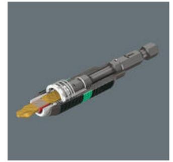
Die Wirkungsweise des BiTorsion-Systems basiert auf der Kombination von zwei schockabsorbierenden Feder-Elementen. Sowohl Bits als auch Halter weisen eine federnde Torsionszone auf, die bei Belastungsspitzen kinetische Energie aus der Abtriebspitze ableitet.
