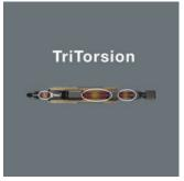
Die Kombination der zweifachen Torsionszonen im Impaktor Halter und der Torsionszone im Impaktor Bit führt zum sogenannten TriTorsion-System.
