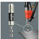
Der Impaktor Edelstahl-Halter mit Sprengring und Magnet wird den dynamischen extremen Anforderungen insofern gerecht, als dass er bewusst mechanisch anfälligere Kleinbauteile verzichtet. Er konzentriert sich auf die elementar notwendige Haltefunktion des Bits und die Abfederung der extremen Impulsspitzen durch zwei differente Torsionszonen. Einsatz vorwiegend in der industriellen Schraubmontage, z. B. mittels Schraubroboter.
