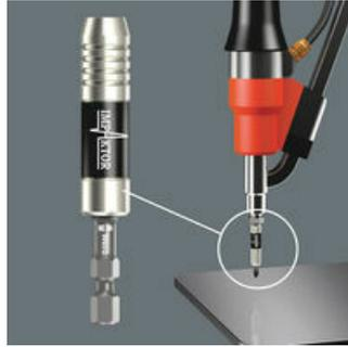
Der Impaktor Edelstahl-Halter mit Sprengring und Magnet wird den extremen dynamischen Anforderungen insofern gerecht, als dass er bewusst auf mechanisch anfälligere Kleinbauteile verzichtet. Er konzentriert sich auf die elementar notwendige Haltefunktion des Bits und die Abfederung der extremen Impulsspitzen durch zwei differente Torsionszonen. Einsatz vorwiegend in der industriellen Schraubmontage, z. B. mittels Schraubroboter.
