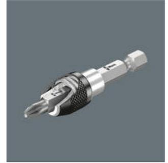
Wera Schnellwechselhalter stellen eine feste, wackelfreie Verbindung zwischen Halter und Bit her. Die Halter sind so konstruiert, dass beim Bitwechsel die äußere Hülse nach vorn geschoben wird und der Bit leicht eingesetzt und entnommen werden kann. In unmagnetischer Ausführung zur Verhinderung des ungewollten Anziehens von Metallspänen.
