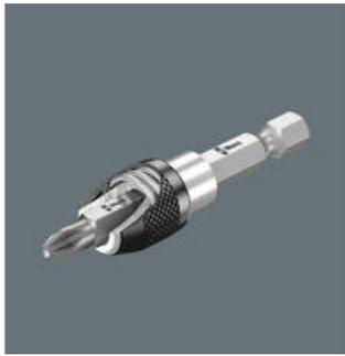
Wera Schnellwechselhalter stellen eine feste, wackelfreie Verbindung zwischen Halter und Bit her. Die Halter sind so konstruiert, dass beim Bitwechsel die äußere Hülse nach vorn geschoben wird und der Bit leicht eingesetzt und entnommen werden kann. In magnetischer Ausführung zum leichteren Ansetzen der Schrauben.
