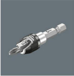
Wera Schnellwechselhalter stellen eine feste, wackelfreie Verbindung zwischen Halter und Bit her. Die Halter sind so konstruiert, dass beim Bitwechsel die äußere Hülse nach vorn geschoben wird und der Bit leicht eingesetzt und entnommen werden kann. In unmagnetischer Ausführung zur Verhinderung des ungewollten Anziehens von Metallspänen.
