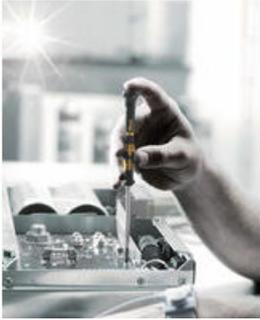
Bei der Verschraubung von Elektronikkomponenten (wie z. B. in Smartphones und Tablet-PCs) dürfen keine elektrostatischen Entladungen auftreten, da diese Fehlfunktionen bis hin zu einem Totalausfall verursachen können. Daher sind elektrostatisch abgesicherte Schraubwerkzeuge unabdingbar.
