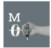
Durch die Armhaltung, bei der die Klingenachse in Verlängerung der Unterarmachse geführt wird, sind besonders hohe Drehmomente erreichbar.
