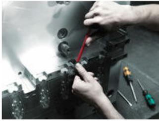
Wir haben die klassischen Winkelschlüssel einfach in Frage gestellt, weil sie beim Arbeiten viel zu oft die Schraubenkopfprofile verrunden. Mit der Folge, dass Schrauben nicht mehr betätigt werden können und man abrutscht. Wera Hex-Plus Werkzeuge haben größere Anlageflächen im Schraubenkopf. Die Kerbwirkung und damit die Deformierung der Schraube werden verringert. Gleichzeitig können bis zu 20 % höhere Drehmomente übertragen werden.
