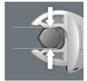
Die parallelen glatten Backen des Joker 6004 VDE ermöglichen eine Flächenpressung und können dadurch das Verrunden der Mutter bzw. des Schraubenkopfes vermeiden, was bei der Kraftübertragung über Ecken auftreten kann.
