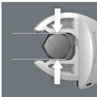
Die parallelen glatten Backen des Joker 6004 VDE ermöglichen eine Flächenpressung und können dadurch das Verrunden der Mutter bzw. des Schraubenkopfes vermeiden, was bei der Kraftübertragung über Ecken auftreten kann.
