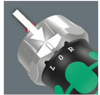
Die Ratschenmechanik ist feinverzahnt für einen geringen Rückholwinkel. Über den Umschaltring kann die Schraubrichtung rechts/fest/links vorgenommen werden. Die magnetische Bitaufnahme ist für Bits mit 1/4"-Außensechskanttrieb nach DIN ISO 1173-C 6,3 und Wera Anschluss-Reihe 1 geeignet.
