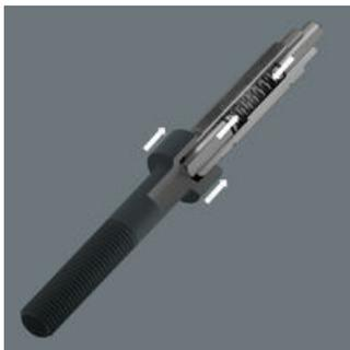
Mit den 4-in-1 Bits 9506 und 9507 können jeweils vier Schraubengrößen betätigt werden. Mit dem 4-in-1 Bit 9506 vier Größen Innensechskantschrauben (3,0; 4,0; 5,0; 6,0), mit dem 4-in-1 Bit 9507 drei Größen Innensechskantschrauben (2,5; 5,0; 6,0) und eine Größe TORX® Schrauben (TX 25). Um das jeweils größere Profil zu verwenden, muss beim Schrauben kontinuierlich gegen die Federkraft gedrückt werden, so dass das kleinere Profil versenkt wird und das größere Profil eingesetzt werden kann.
