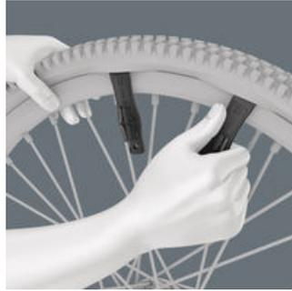
Mit den glasfaserverstärkten Reifenhebern aus Kunststoff lassen sich die Reifen sicher von der Felge hebeln, ohne die Felge zu beschädigen. Mit dem einen Reifenheber von der Felge abheben, in einer Speiche einhaken und mit dem zweiten Reifenheber den Reifen abziehen. Die beiden Reifenheber lassen sich ineinanderklicken und gehen so nicht einzeln verloren.
