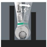
Der Ringmaulschlüssel Joker 6003 besonderen seiner Maulgeometrie - eine um 7,5° geschwenkte Maulseite und die Doppelsechskantgeometrie verdoppelt die Ansetzmöglichkeiten bei wiederholter 180°-Drehung des Schlüssels um die Längsachse. Muttern bzw. Schraubenköpfe 15° können alle "gepackt" werden. Den jeweiligen Ansetzpunkt findet der Joker 6003 nach jedem Wenden sozusagen von selbst.
