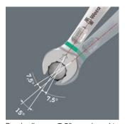
Durch die um 7,5° geschwenkte Maulseite, Doppelsechskantgeometrie eine angepasste Anwendungsweise (Ansetzen Schrauben - Drehen - erneut Ansetzen - Schrauben - Drehen usw.) können auch Schraubsituationen gelöst werden, als die weniger 30° Schwenkwinkel zulassen.
