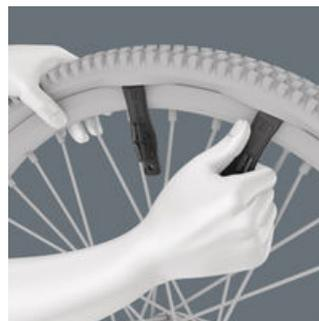
Mit den glasfaserverstärkten Reifenhebern aus Kunststoff lassen sich die Reifen sicher von der Felge hebeln, ohne die Felge zu beschädigen. Mit dem einen Reifenheber von der Felge abheben, in einer Speiche einhaken und mit dem zweiten Reifenheber den Reifen abziehen. Die beiden Reifenausheber lassen sich ineinanderklicken und gehen so nicht einzeln verloren.
