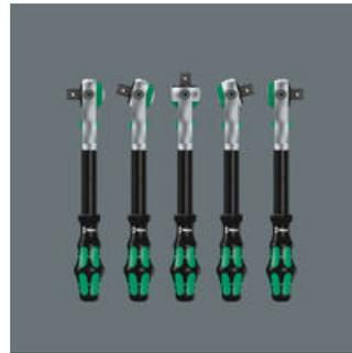
Der Knarrenkopf ist frei schwenkbar und kann durch den beidseitig angebrachten Schiebeschalter in jeder Fixierungsposition verriegelt werden. Problemloses Arbeiten mit großem Handfreiraum ist selbst in sehr engen oder schwer zu erreichenden Einbausituationen möglich. Die definierte Fixierung bei 0°, 15° und 90° nach links und rechts garantiert sicheres Arbeiten ohne Verrutschen des Knarrenkopfes.
