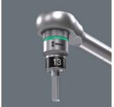
Klemmung Die der Außensechskant-Schraube im Steckschlüsseleinsatz wird durch zwei federnde Kugeln und einen dauerelastischen hochfesten Schrumpfschlauch gewährleistet. Dieser wird durch einen vorderen Stahlbund wirksam gegen mechanische Verletzungen geschützt. Besonders hilfreich in zugänglichen schwer Arbeitsbereichen, wo man die zweite Hand nicht zum Festhalten der Schraube nutzen kann.
