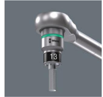
Die Klemmung der Außensechskant-Schraube im Steckschlüsseleinsatz wird durch zwei federnde Kugeln und einen dauerelastischen hochfesten Schrumpfschlauch gewährleistet. Dieser wird durch einen vorderen Stahlbund wirksam gegen mechanische Verletzungen geschützt. Besonders hilfreich in schwer zugänglichen Arbeitsbereichen, wo man die zweite Hand nicht zum Festhalten der Schraube nutzen kann.
