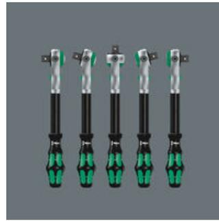
Der Knarrenkopf ist frei schwenkbar und kann durch den beidseitig angebrachten Schiebeschalter in jeder Fixierungsposition verriegelt werden. Problemlos Arbeiten mit großem Handfreiraum ist selbst in sehr engen oder schwer zu erreichenden Einbausituationen möglich. Die definierte Fixierung bei 0°, 15° und 90° nach links und rechts garantiert sicheres Arbeiten ohne Verrutschen des Knarrenkopfes.
