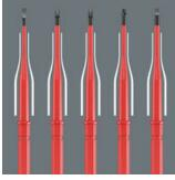
Reduzierter Klingendurchmesser mit integrierter Schutzisolation, so können tiefliegende Schraub- und Federelemente erreicht und betätigt werden, stückgeprüft gemäß IEC 60900.
