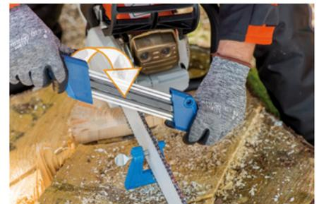
Das Kettensägeschärfgerät CHAIN SHARP CS-X vereint die Funktionen einer Tiefenbegrenzerfeile und einer Kettensägefeile in einem Gerät. So kann die Zahnschneide geschärft werden, während gleichzeitig der Tiefenbegrenzer justiert wird. Scannen Sie den QR-Code, um mehr über Kettensägeschärfgeräte von PFERD zu erfahren.
