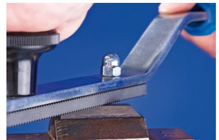
Für eine optimale Feilführung, beste Arbeitsergebnisse und einen schnellen Werkzeugwechsel empfiehlt PFERD den Einsatz von Hartmetallfeilen auf den speziell entwickelten wiederverwendbaren, ergonomisch geformten Feilenhaltern mit Ergonomie-Feilenheft. Scannen Sie den QR-Code, um mehr über Hartmetallfeilen von PFERD zu erfahren.
