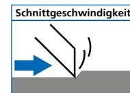
Die Schnittgeschwindigkeit ist die Geschwindigkeit, mit der eine Werkzeugschneide in Schnittrichtung durch den zu bearbeitenden Werkstoff geführt wird und einen Span abnimmt.
