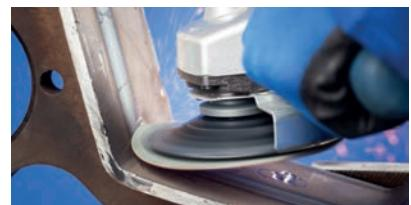
Meulage frontal particulièrement tendre et flexible avec les disques fibre de Ø 125 mm.
