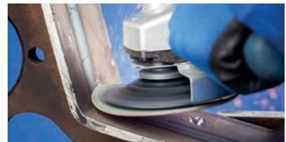
Besonders weiches und flexibles Schleifverhalten im Stirnschliff mit Fiberschleifer Ø 125 mm.
