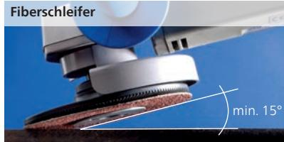
Mit COMBICLICK werden Kratzer durch hervorstehende Spannteile vermieden und eine sehr hohe Ausnutzung des zur Verfügung stehenden Schleifmittels erzielt.
