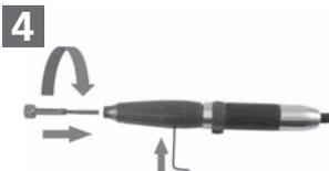
4. Die Spindel durch die Öffnung der Abdeckschraube arretieren und die Spannzange mithilfe des Schlüssels eindrehen
