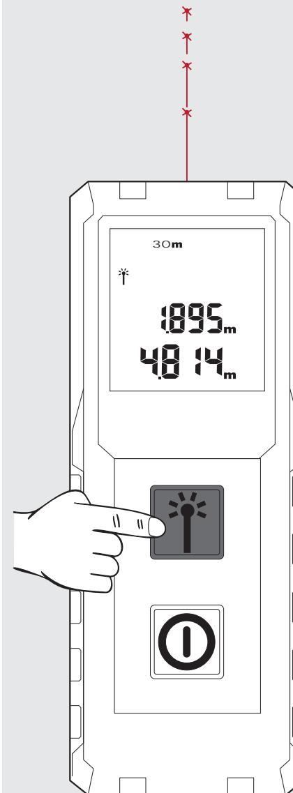
További mérés indításához nyomja meg ismét a mérés gombot. Az előző mérés az előzmény mezőbe kerül.
