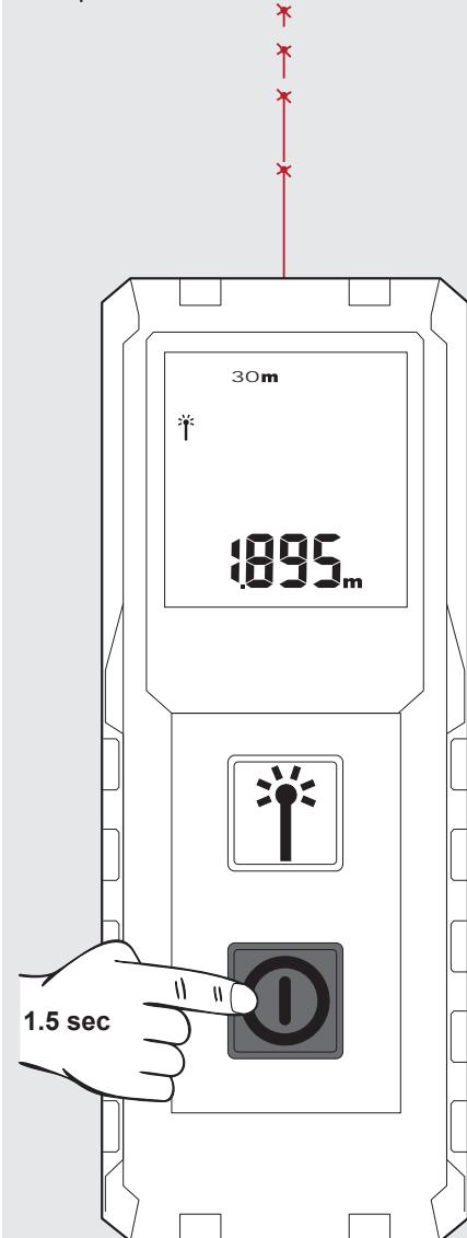
За да замразите измерването, натиснете бутона за измерване.
