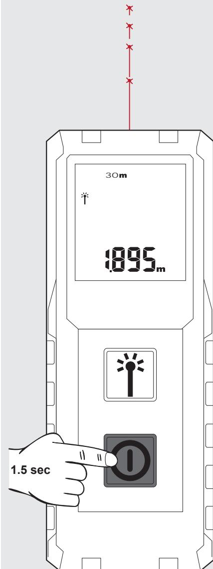
A mérés befagyasztásához nyomja meg mérés gombot.
