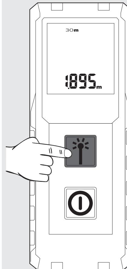
Paina mittausnäppäintä uudelleen aloittaaksesi seuraavan mittauksen. Edellinen mittaus siirretään sen yläpuolella olevaan tallennusruutuun.
