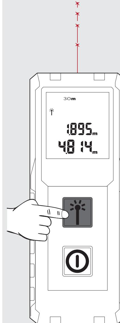
Apăsați din nou tasta Măsurare, pentru a porni o nouă măsurare. Măsurarea anterioară este deplasată în câmpul de memorare superior.
