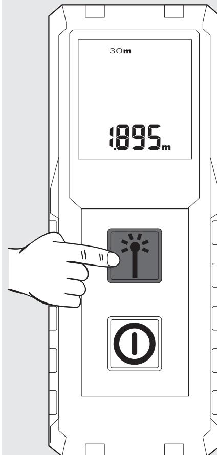
Pressione novamente a tecla de medição para iniciar uma medição nova. A medição precedente é deslocada para o campo de memória acima.
