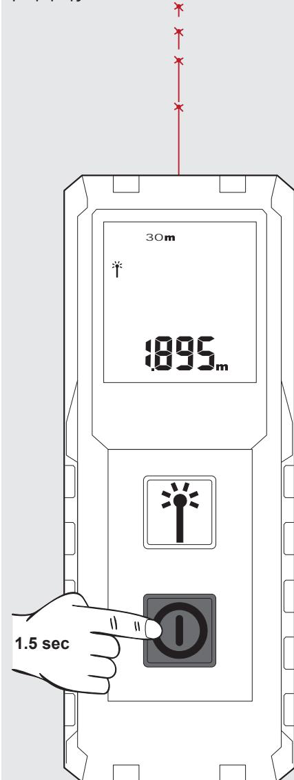
Για το πάγωμα της μέτρησης πιέστε το πλήκτρο μέτρησης.
