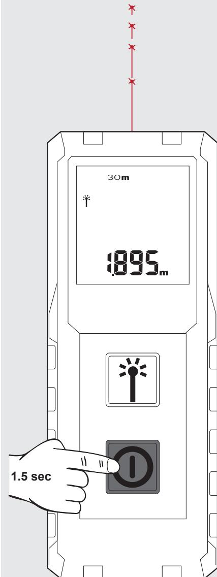
Ölçümü dondurmak için ölçüm tuşuna basınız.
