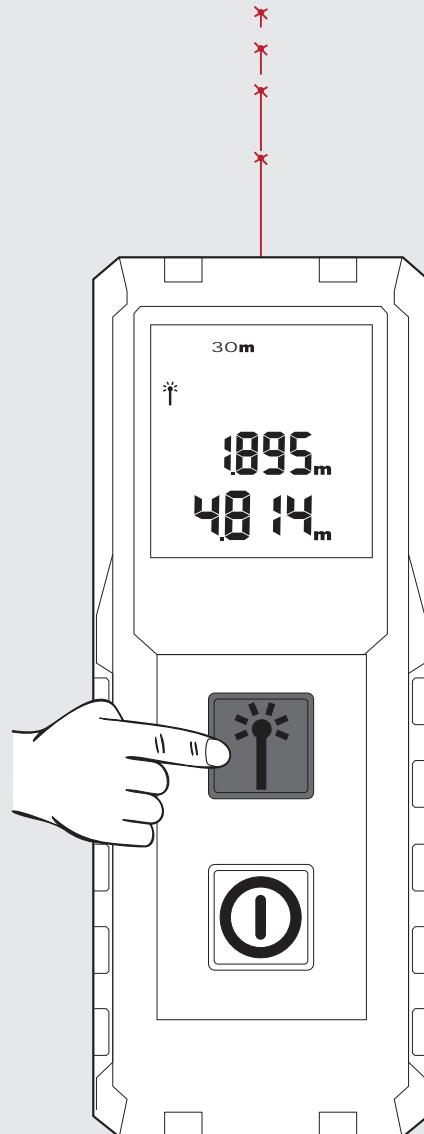
Appuyer de nouveau sur la touche Mesure pour démarrer une nouvelle mesure. La mesure précédente sera déplacée dans le champ de mémoire au dessus.
