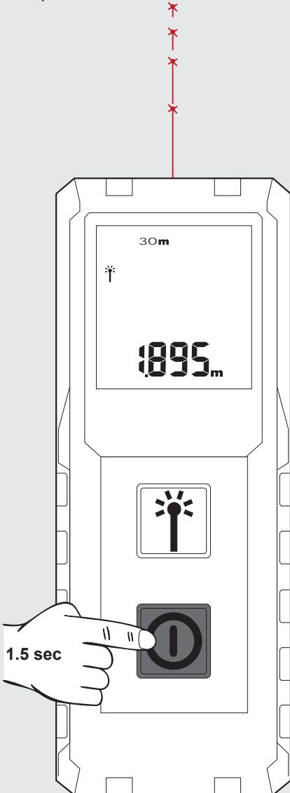
Чтобы зафиксировать измерение, нажмите на кнопку измерения.
