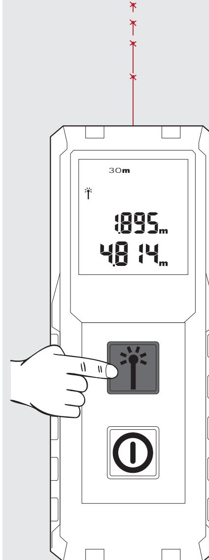
Снова нажмите кнопку измерения, чтобы начать следующее измерение. Предыдущее измерение переместится в поле памяти.
