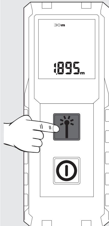
Πιέστε πάλι το πλήκτρο μέτρησης, για να ξεκινήσετε μια νέα μέτρηση. Η προηγούμενη μέτρηση μετατοπίζεται στο πεδίο απομνημόνευσης από πάνω.
