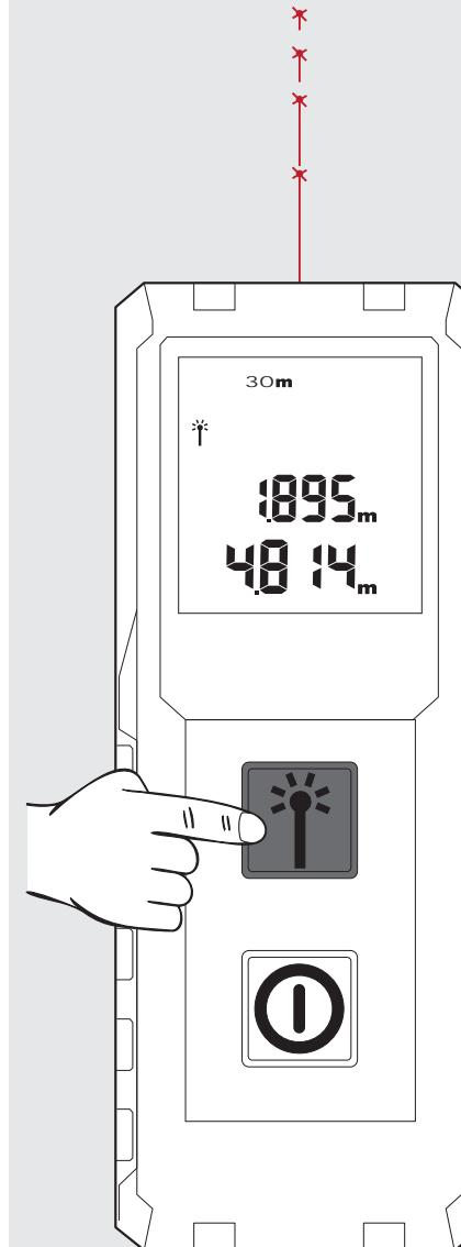
Paina mittausnäppäintä uudelleen aloittaaksesi seuraavan mittauksen. Edellinen mittaus siirretään sen yläpuolella olevaan tallennusruutuun.
