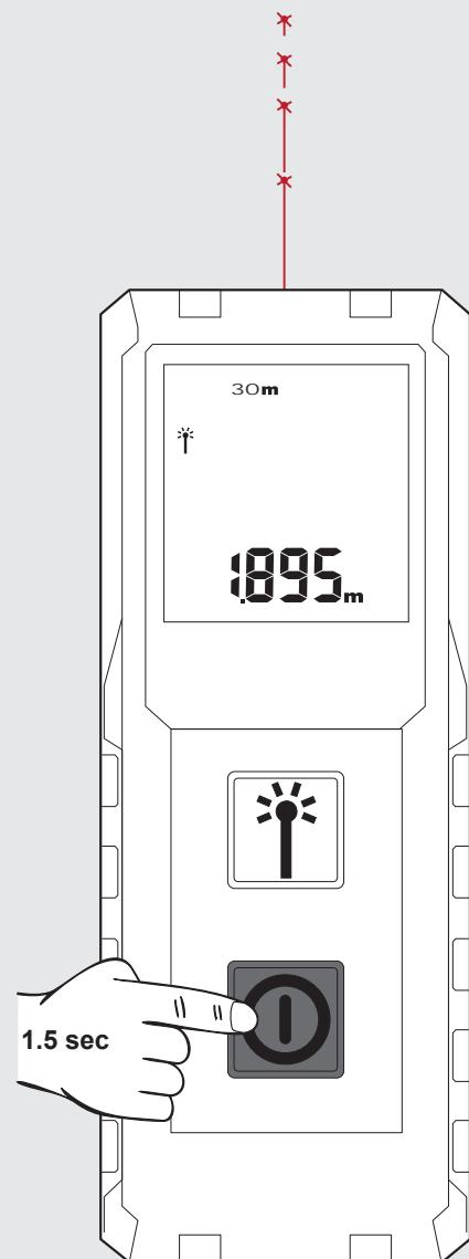
Aby zapisać pomiar, należy wcisnąć przycisk pomiaru.
