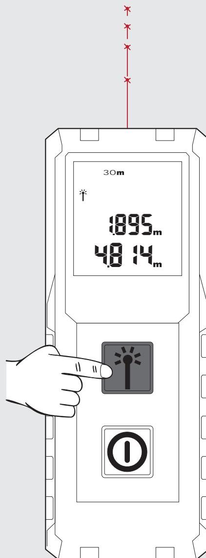
Знову натисніть кнопку вимірювання, щоб
