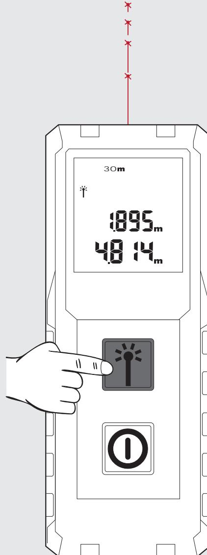
Πιέστε πάλι το πλήκτρο μέτρησης, για να ξεκινήσετε μια νέα μέτρηση. Η προηγούμενη μέτρηση μετατοπίζεται στο πεδίο απομνημόνευσης από πάνω.
