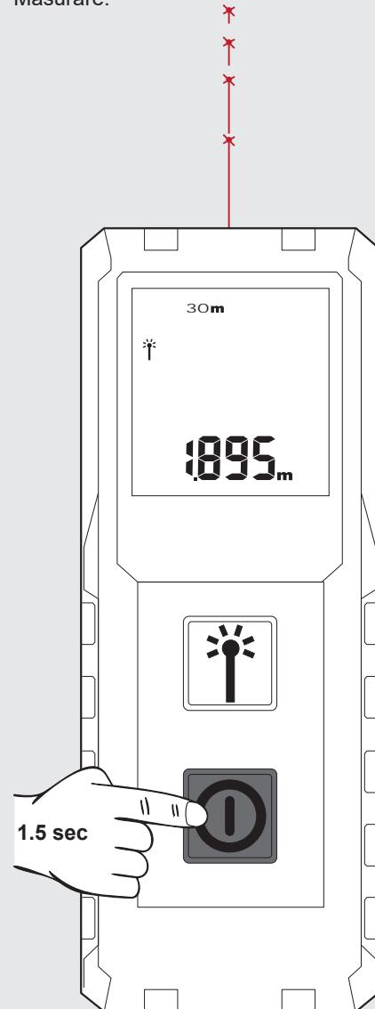
Apăsați din nou tasta Măsurare, pentru a porni o nouă măsurare. Măsurarea anterioară
