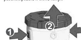
Удалить короткие остатки лески. Затем надеть кожух на режущую головку и защелкнуть его на выступах.
