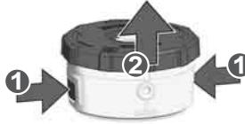
Uklonite kratke ostatke strune. Ponovo postavite poklopac na glavu sečiva i uglavite na spojnice.
