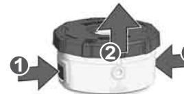
Kratke ostatke sajle otkloniti. Zatim pokrov ponovno postaviti na reznu glavu i uskočiti na spojnicu.
