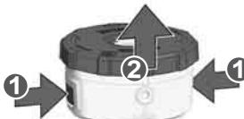
Attīriet no ūsajiem troses gabaliem. Tad atkal uzlieciet pārsegū uz griešanas galvas un notīksejiet to uz savienotāju.
